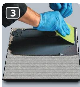
3 Нанесение специальной смолы ЗХ на РОЛЛЕРКИТ®
