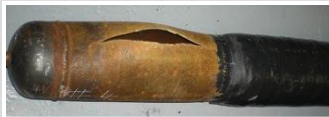
Ремонт участков с продольными трещинами: 350 Бар
