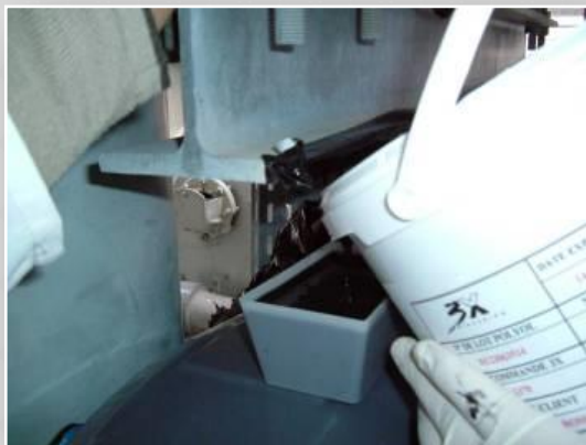
Через специальную воронку заливаем смолу
