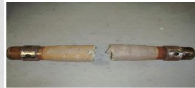
Испытание на осевой разрыв: 62 тонны
